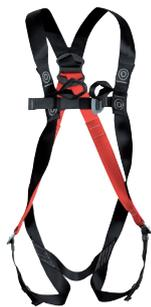
Kit conçu pour être utilisé sur les **échafaudages** et dans les **différents secteurs du bâtiment**. Le kit est constitué d'un harnais et d'une longe double avec absorbeur d'énergie et de connecteurs. La longe double avec absorbeur permet à l'utilisateur de se déplacer en gardant toujours un connecteur lié à un point d'ancrage. **Le kit est adapté pour arrêter la chute.**
