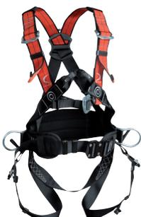
Kit conçu pour être utilisé sur **treillis, escaliers et d'autres structures verticales**. Le kit est constitué d'un harnais avec ceinture, une longe double avec absorbeur d'énergie et de connecteurs et une longe de maintien et retenue avec connecteurs. **Le kit est adapté pour arrêter la chute et permet le maintien en position de travail.**
