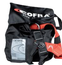
Kit conçu pour être utilisé sur les **plateformes de travail élévatriques à bras**, pour les **échafaudages** et dans les différents **secteurs du bâtiment**. Le kit est constitué d'un harnais et d'une longe simple avec absorbeur d'énergie et de connecteurs. **Le kit est adapté pour arrêter la chute.**
