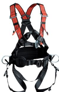
Kit conçu pour être utilisé sur **surfaces inclinées**. Le kit est constitué d'un harnais et une longe de maintien et retenue de 5 m avec connecteurs. **Le kit est adapté pour la retenue et le maintien en position de travail.**
